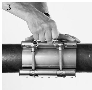
Verschluss einhaken. Schrauben abwechselnd und gleichmäßig anziehen.
